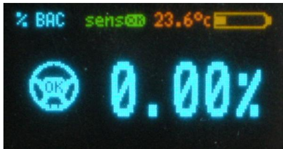
Рисунок 7 – результат измерения в %BAC (содержание алкоголя в крови – результат получается путем пересчета из соотношения: 1%BAC = 0,05мг/л)
