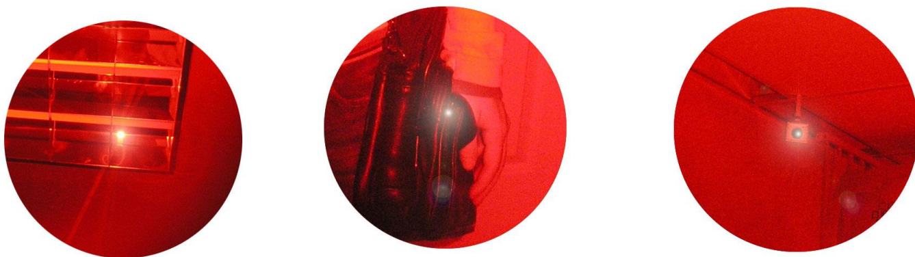
Рисунок 4 – вид блика камеры в объективе прибора (а – камера, скрытая в светильнике; б – камера в дамской сумочке; в – камера видеонаблюдения в магазине)
